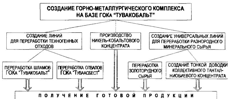
Рис. 2. Схема работы горно-металлургического комплекса на базе ГОКа «Тувакобальт»
