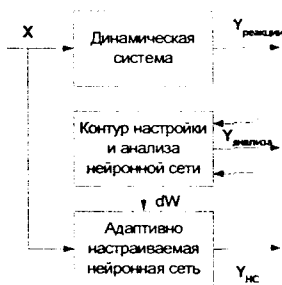
Рис. 1. Структура нейросетевой модели для анализа поведения динамической системой.
