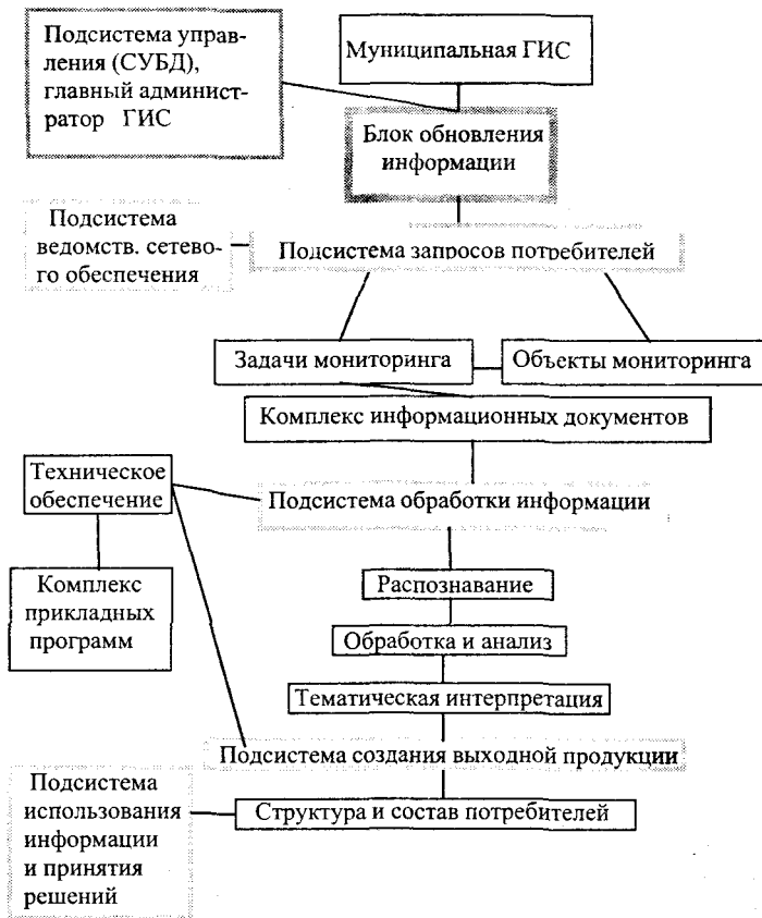
Рис.3.2. Структура блока обновления информации
