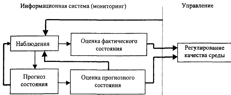
Рис. 2.2. Блок-схема системы управления качеством природной среды [28]
