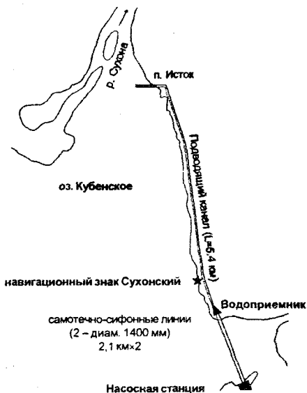
Рис. 3.11. Схема расположения сооружений водозабора для г. Вологды
